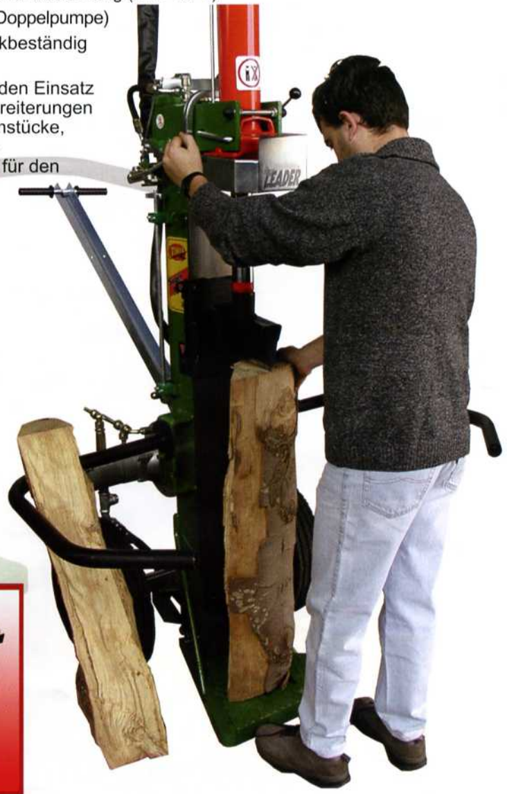
Tisch für nur 50 cm Spalthöhe mit seitlichen Verbreiterungen und Pedalsteuerung für das Ausrichten des Spaltholzes! Artikelnr. 845.034.K
