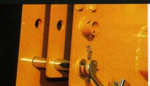
Dreipunktbau: Sie können zwischen 2 unterschiedlich hohen Anschlusspunkten wählen.
