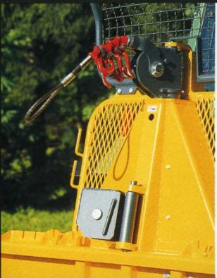
Alle Kugellager sind in Doppel-Z -Ausführung. Diese verbindet hohe Präzision mit geringem Wartungsaufwand. Nachschmieren ist nicht notwendig. Egal ob 3,5 oder 8 to, die untere Umlenkrolle ist serienmäßig.
