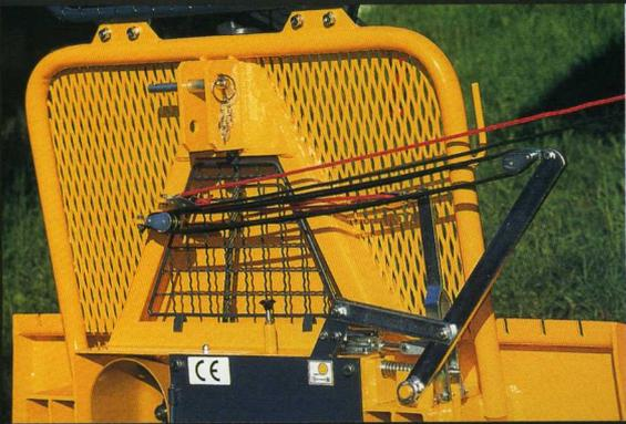
Der stabile Windenrahmen mit integriertem Seilschutz, bietet ein Höchstmaß an Sicherheit und Einsatzfähigkeit beim Poltern.
