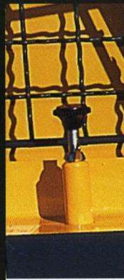
Die Nachlaufbremse der Seiltrommel ist leicht einstellbar.
